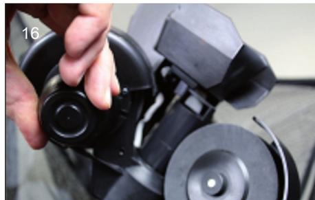
Ahora podrá extraer el disco del eje del motor y cambiarlo por uno nuevo (Fig.17a y 17b).
